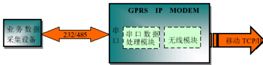
图3：GPRS/CDMA 专用数据终端内部功能示意图
